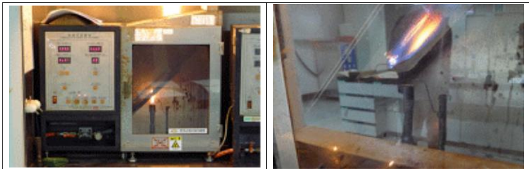
<그림 3-1> 방음터널 사용재료에 대한 45° 연소시험
