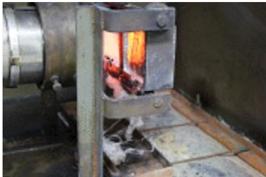
<그림 3-6> ASTM E662에 의한 연기밀도 시험 중 녹아내린 시편
