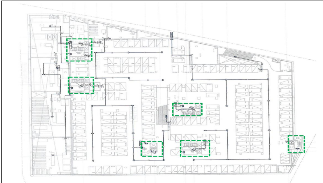
<그림 3-9> 지하주차장 계단 및 승강장 출입구의 비대칭 구조
