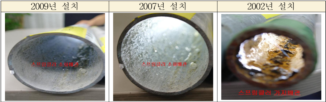
<그림 3-3> 2012년 OO캠퍼스 스프링클러 배관 육안 점검 결과
