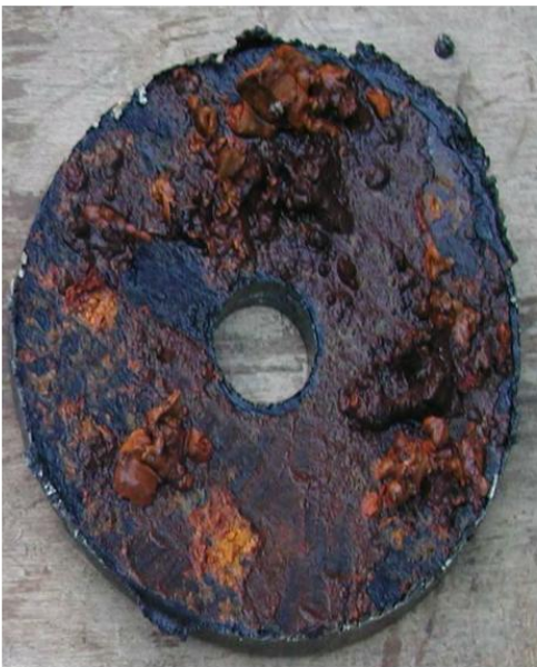
<그림 2-14> 미생물에 의한 부식이 촉진된 상태
